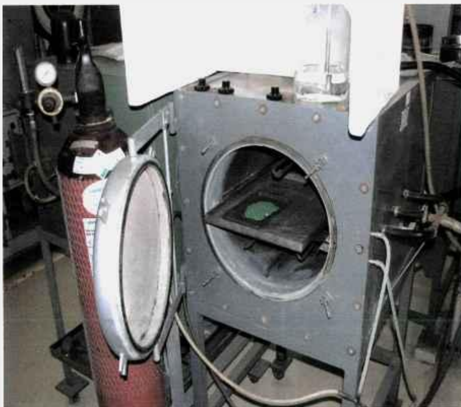
Figura 5 – Forno resistivo Grion para temperaturas até 400 °C.
