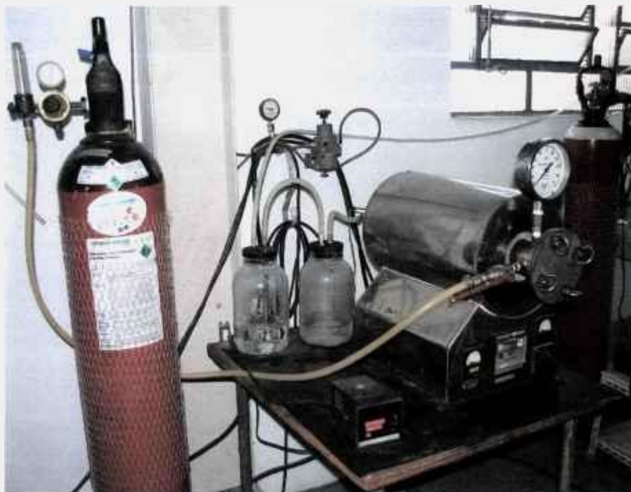
Figura 6 – Forno resistivo F.E.L. para temperaturas até 1000°C.
